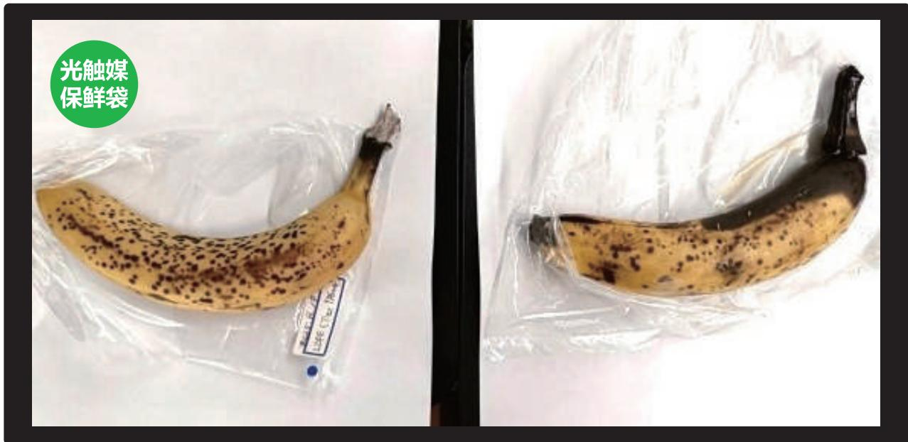
本次的光触媒母粒采用本公司研发的磷灰石包覆二氧化钛加工制成，其杀菌效果源于磷灰石的吸附特性与二氧化钛的氧化作用。该产品通过吸附腐败过程中产生的乙烯，并借助二氧化钛进行氧化分解，从而实现杀菌效果。
